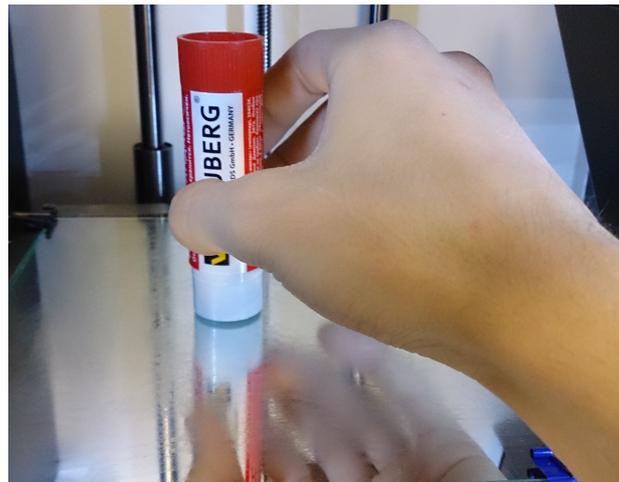
2. Нанесите на стол равномерным слоем клей-карандаш, который идёт в комплекте с принтером.
