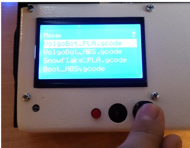
3. Выберите функцию "Меню">"Обзор карты" и выберите файл «VolgoBot\_ABS.gcode» или «VolgoBot\_PLA.gcode» в зависимости от используемого пластика.
