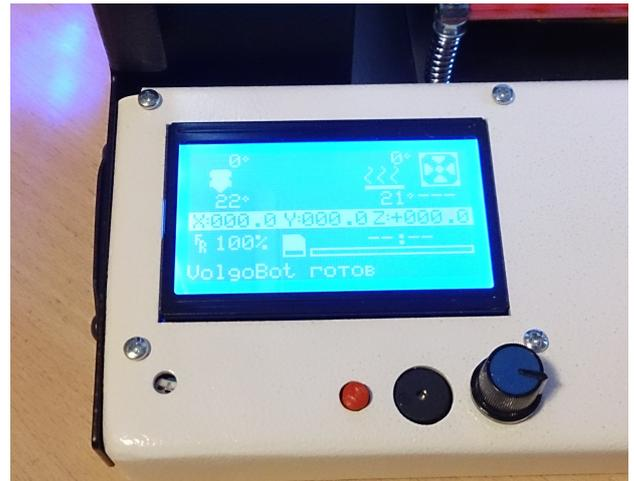
4. При включении принтера включатся внутренняя подсветка и вентиляторы, на дисплей выводится приветствие.
