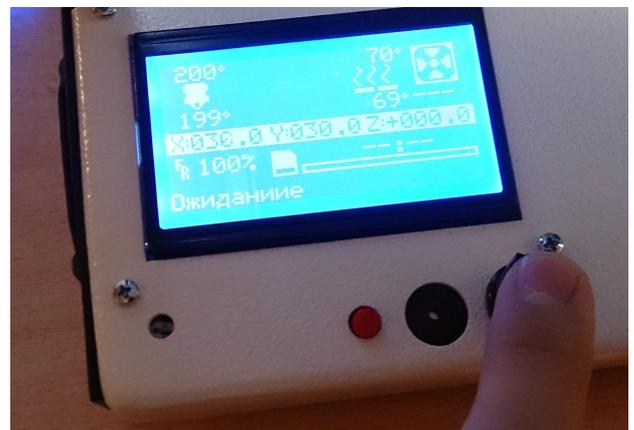
4. Нажмите на джойстик, чтобы перевести экструдер к другой точке калибровки. Повторяйте пункты 3 и 4, когда калибровка будет закончена, оси принтера уйдут в домашнее положение.
